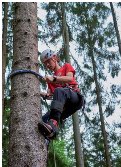
Helfen beim Klettern: Baumsteigeisen, Sicherungsgurt und Halteseile
